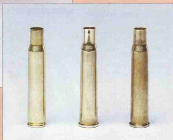
V.l.n.r.: Hülse Kal. .30-06 Sprgf., .30-06 R um- geformt aus einer 9,3 x 74 R und rechts ebenfalls .30-06 R umgeformt aus einer 7 x 65 R, bei der der ehemalige Übergang Hals/Schulter nun- mehr als Ring im Hals erscheint.
