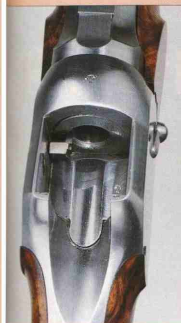
Neben der Ausfräsung im Lauf und Auszieher für den Patro- nenrand ist hier im Auszieher für die randlose Version zusätz- lich eine Auszieherkralle.
